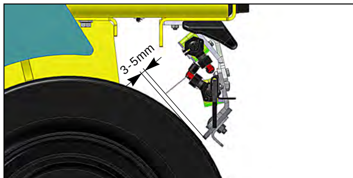
Fig. 9-26 Distanza dello slingottatore dall'asse delle ruote pneumatiche
