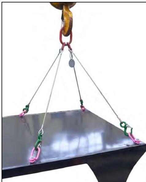
Fig. 8-10 Sollevare la parte inferiore ROPS
