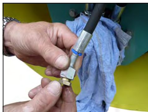
Fig. 9-32 Smontare il tubo flessibile del freno e chiudere a pressione.
