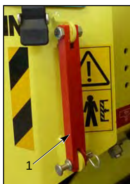
Fig. 12-1 Dispositivo di protezione dell'unità pieghevole aperto/Dispositivo di protezione dell'unità pieghevole bloccato
