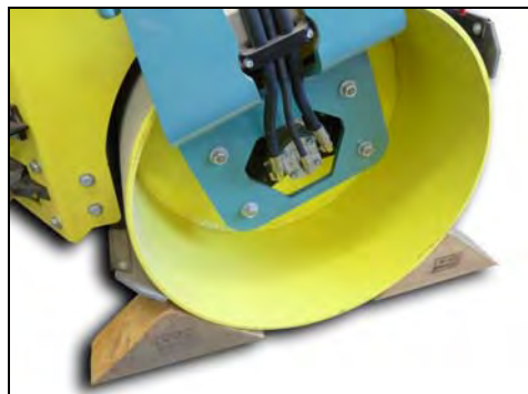
Fig. 9-1 Bloccare il compressore stradale tramite dei cunei per evitare spostamenti
