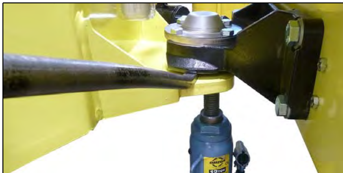
Fig. 9-36 Sostenere con il sollevatore idraulico
