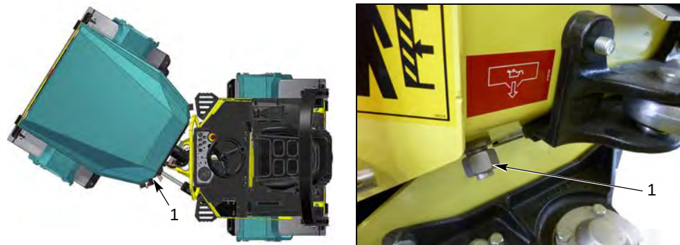
Fig. 9-12 Compressore stradale orientato/Scarico dell'olio del motore
