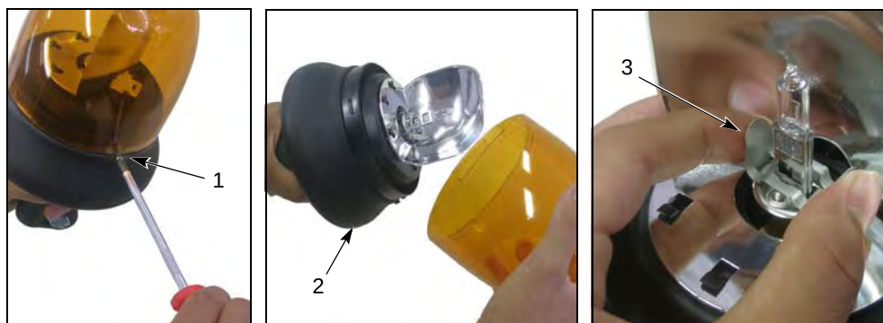
Fig. 8-6 Sostituzione della lampada ad incandescenza
