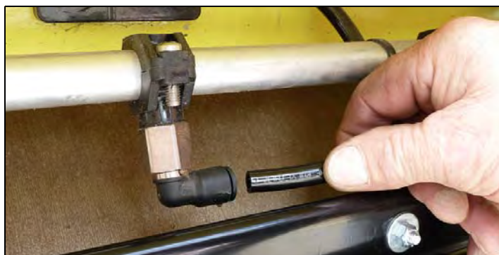
Fig. 11-1 Scaricare l'acqua di irrigazione.
