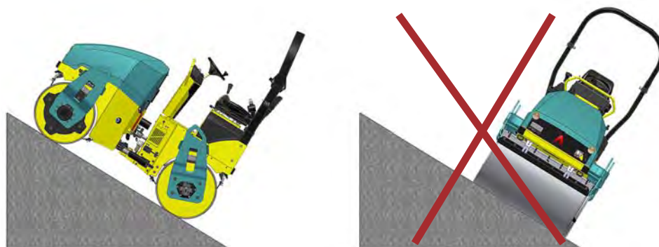
Fig. 3-1 Pericolo di rovesciamento
