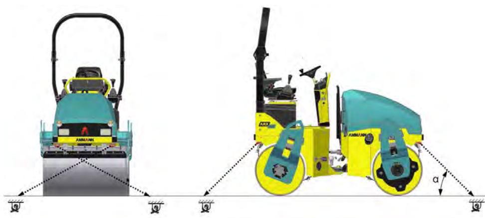
Fig. 12-5 Ancoramento del compressore stradale/Vista laterale
