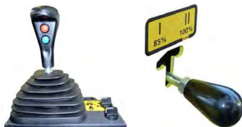
Fig. 7-5 Avviare il motore/posizione leva di guida e leva di regolazione del numero di giri
