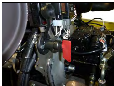
Fig. 8-17 Disattivazione dell'alimentazione di corrente
