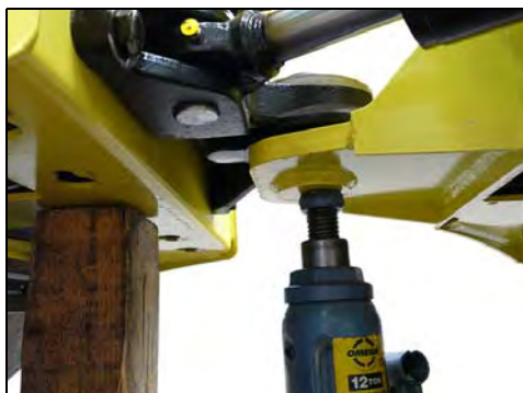
Fig. 9-34 Sostenere con il sollevatore idraulico
