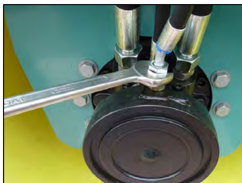
Fig. 9-32 Smontare il tubo flessibile del freno e chiudere a pressione.
