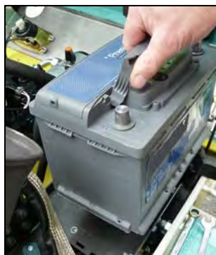
Fig. 10-2 Sostituzione della batteria
